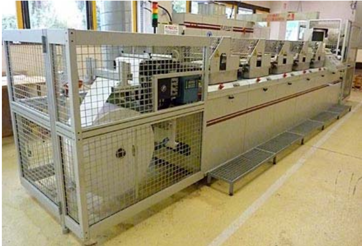
Figure 42 - La Flexiane ® , presse flexographique de Grenoble INP-Pagora, fabrique et imprime des étiquettes
